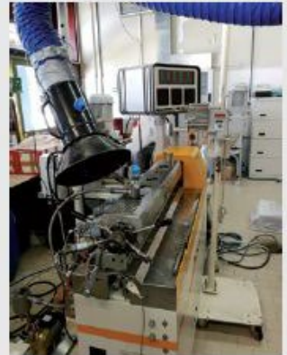
Laboratorio di ingegneria industriale: estrusore bi-vite / Laboratory of industrial engineering: twin screw extruder
