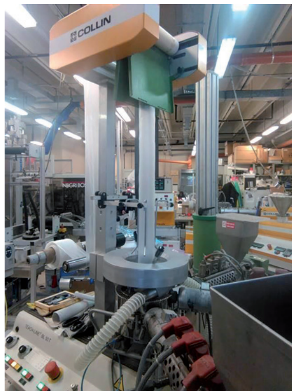
Laboratorio di ingegneria industriale: impianto pilota per film in bolla / Laboratory of industrial engineering: pilot system for blown film
